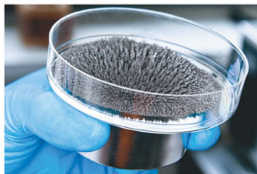
Figura 1.58 Efectos del campo magnético de un imán sobre limadura de hierro.
