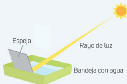
Figura 3.12 Esquema del dispositivo que armarán para la actividad experimental.
