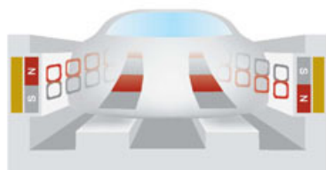
Figura 1.93 Los imanes se encuentran en las partes laterales y en la base del tren, lo que genera que se eleve.
