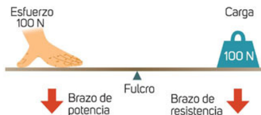
Figura 1.49 El fulcro divide a la palanca en dos brazos.
