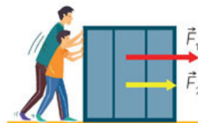
Figura 1.38 Representación de dos fuerzas de distinta magnitud, pero con la misma dirección.
